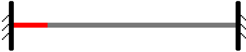
FIGURE 2.1 – Corde vibrante, dont les extrémités sont fixées, avec observation de la vitesse sur la partie en rouge.
